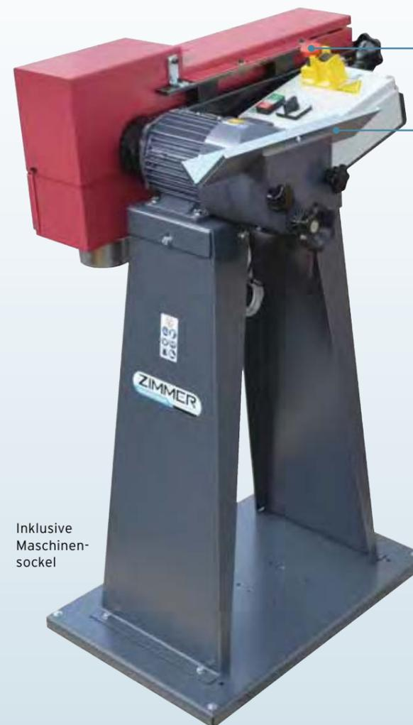
Mit Not-Aus-Taster und 24 V Sicherheitsvorrichtung
