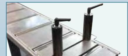
Vertikalspannstöcke (S-WZ61 oder S-WZ62)
