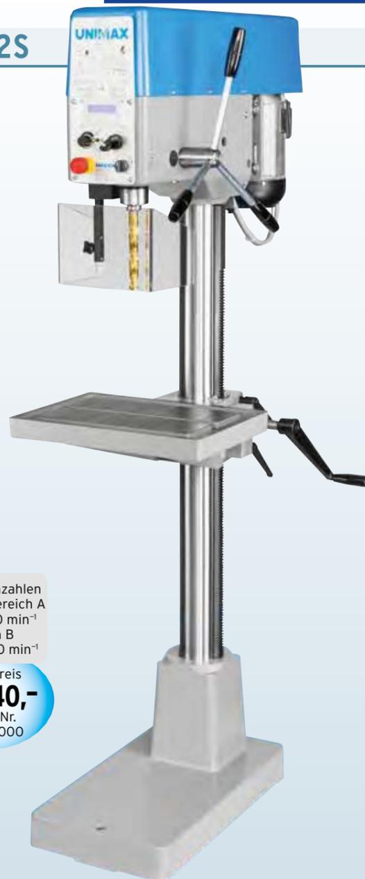
Kräftige, präzise Universalbohrmaschine mit großem Einsatzbereich. Tisch-/Höhenverstellung über Zahnstange und Schneckengetriebe. Drehstrommotor, Wendeschalter Rechts-/Linkslauf, digitale Drehzahlanzeige, Drehzahlverstellung über Potentiometer.
