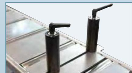
Vertikalspannstöcke (S-WZ61 oder S-WZ62)
