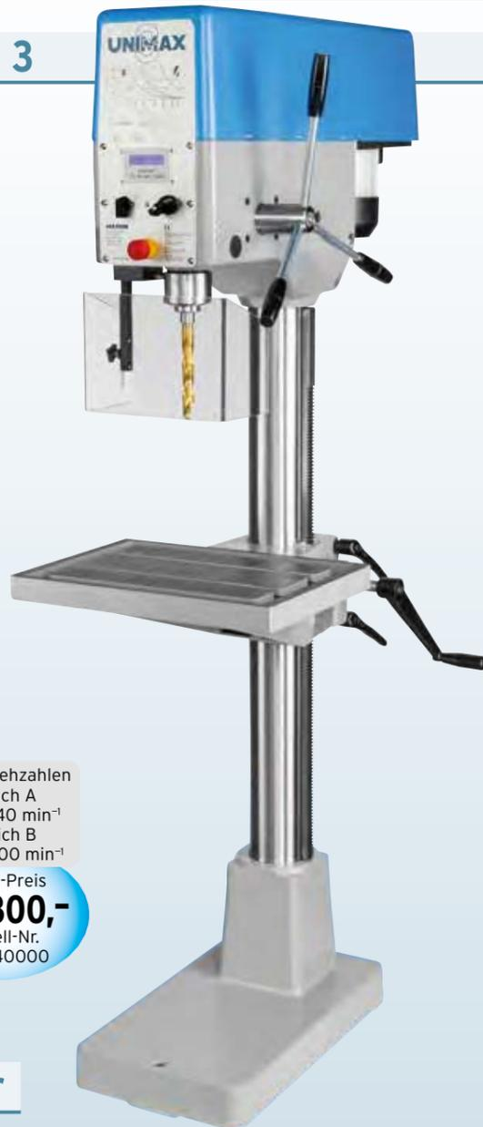
Starke, präzise Bohrmaschine mit großem Einsatzbereich. Höhenverstellung über Zahnstange und Schneckengetriebe. Wendeschalter Rechts-/Linkslauf, digitale Drehzahlanzeige, für Fräspaket vorbereitet standardmäßig mit durchbohrter Spindel.
