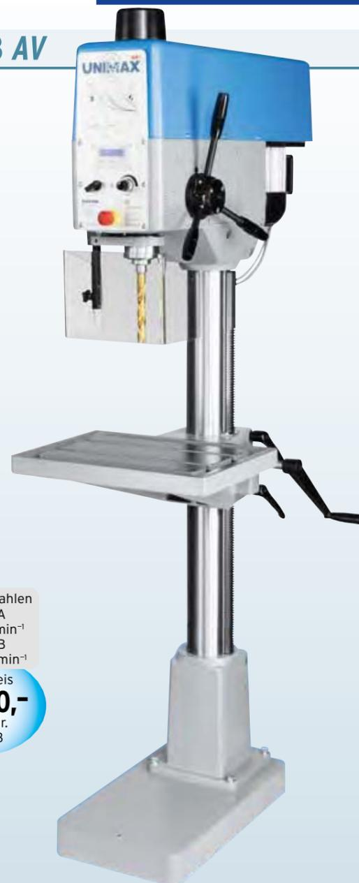
Moderne, präzise Produktionsbohrmaschine nach bewährtem UNIMAX-3-Konzept, mit stufenlosem Vorschubantrieb, automatischem Werkzeugauswerfer und serienmäßiger Spanbruchsteuerung. Im Display werden Vorschub, Drehzahl und Bohrtiefe angezeigt und die Bohrtiefe programmiert.
