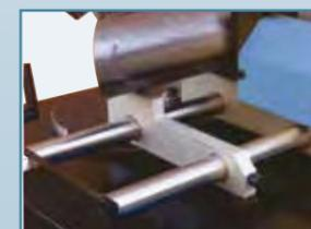
Gleitende Spannbacken auf verchromter Stange und selbstschmierender Buchse
