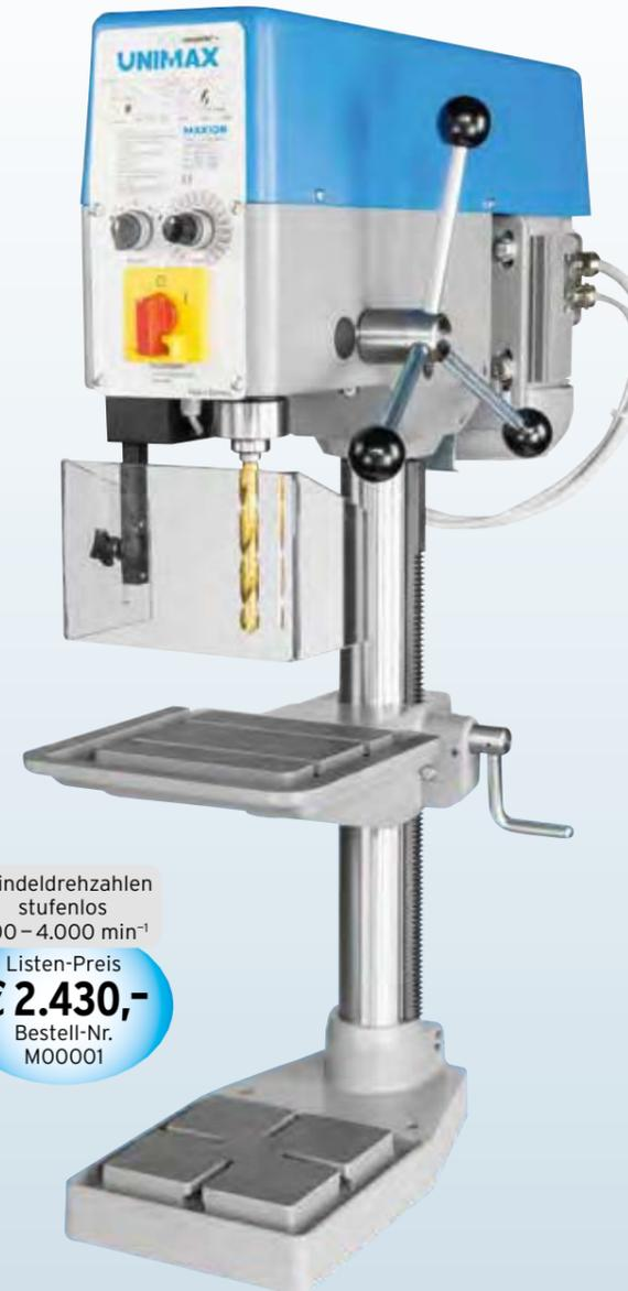
Präzise, lauf ruhige Standardbohrmaschine, mit hoher Genauigkeit und Qualität. Schalter für Rechts-/Linkslauf, Bohrtisch über Zahnstange verstellbar und um die Säule schwenkbar. Tisch-/Höhenverstellung über Zahnstange und Schneckengetriebe.
