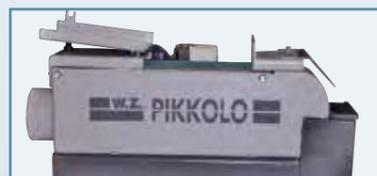
Klappe geöffnet zum Flächenschleifen kleiner Werkstücke
