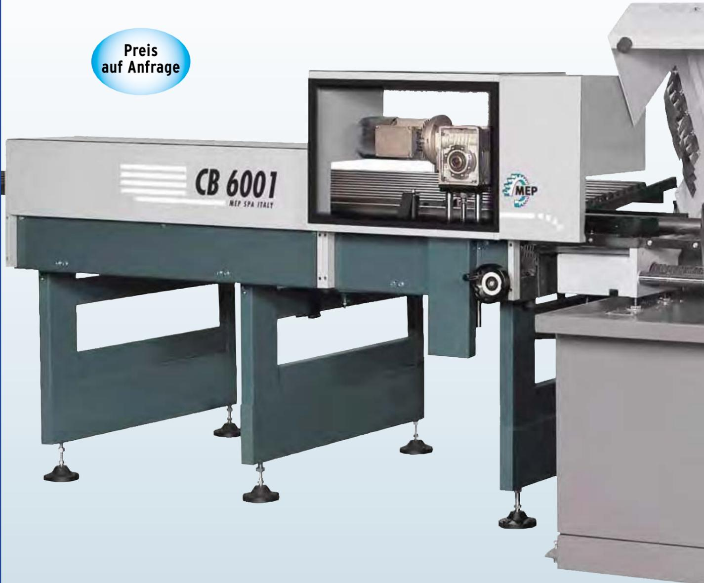
Lademagazin mit Rutsche für Stangenlänge bis 6.000 mm
