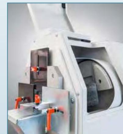
Geöffneter Arbeitsraum mit Endschalter, gute Zugangsmöglichkeit
