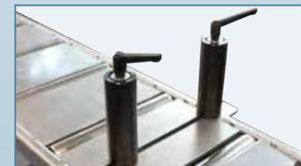
Vertikalspannstöcke (S-WZ61 oder S-WZ62)
