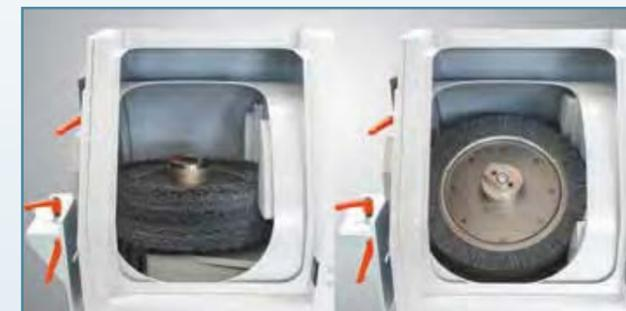
Fliegend gelagerte Bürstspindel ermöglicht einfachen und schnellen Bürstwechsel
